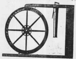
Roue hydraulique à augets.
