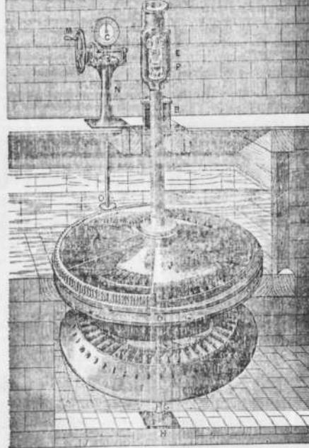
**Turbine hydraulique système Girard**
